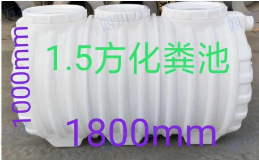
土方开挖→基层处理→吊装化粪池→分层夯实回填→砌检查井→地面处理。土方开挖开挖坑槽尺寸应根据化粪池容量大小进行开挖，施工方根据土壤类别而实施，坑槽深度根据室外管道标高确定。. 基层处理将基底土层整平夯实后，浇筑 $100\text{mm}$ 厚混凝土作为化粪池的基层。. 吊装化粪池将化粪池吊入坑内后，调整化粪池的平衡，进行安装进出水管，然后将化粪池灌水至排水口水平线。. 分层夯实回填用沙土将坑内所余空间填满至顶端。. 切检查井在化粪池进水口，检查口，清理口，出水口位置切筑检查井至室外地面上标高。模压化粪池的选用根据不同建筑物，由单项工程设计人员计算得出设计参数。模压化粪池的地点设置，原则以不影响建筑基础即可；一般距离生活饮用水池不得小于 $10\text{m}$ ，距离地下取水构筑物不得小于 $30\text{m}$ ；当建筑物基础平面高于化粪池基础平面时，化粪池外壁距离不宜小于 $2\text{m}$ ；当建筑物基础平面低于化粪池基础平面时，化粪池外壁距离建筑物外墙净距不宜小于 $5\text{m}$ 。
