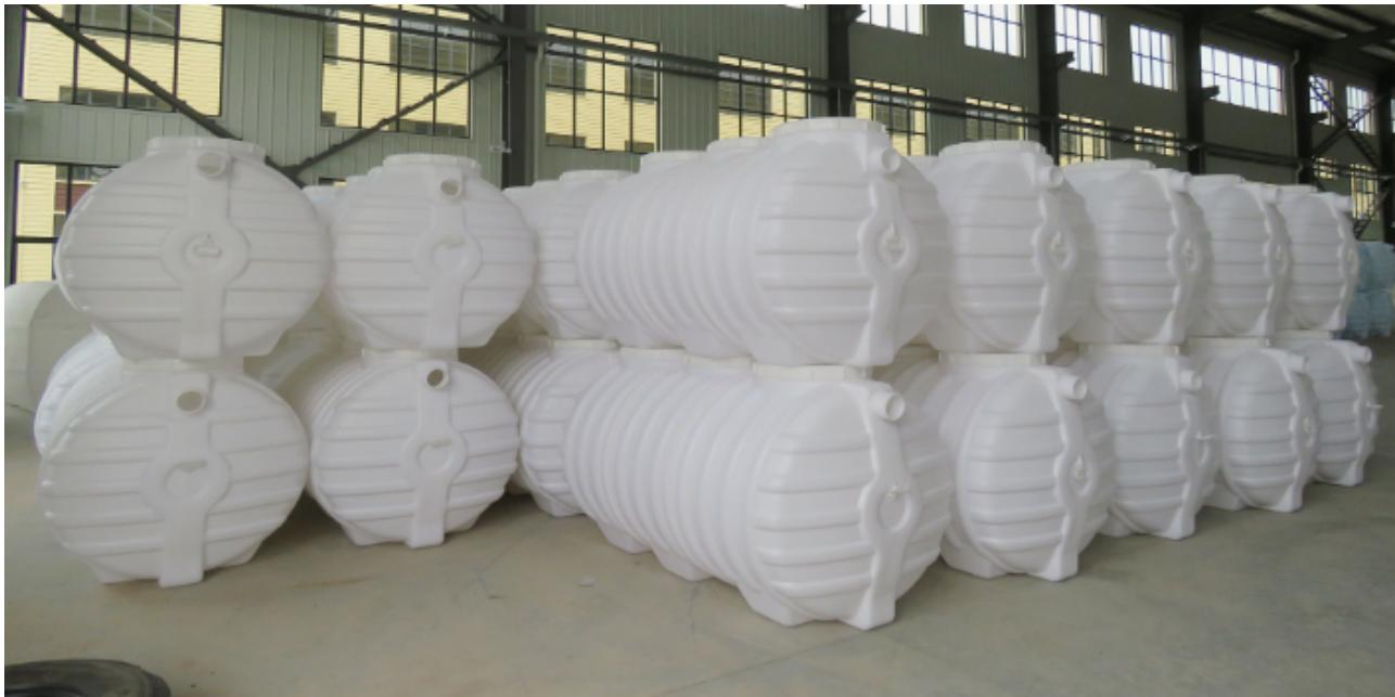
模工序停止模具，转入上/下料工位，开启模具，取出制品。清洁模具，下一循环制作。塑料化粪池滚塑成型，又称旋转成型，通常用于生产空心结构制品。这一成型工艺，适用于热塑性塑料，有时也适用于某些热固性塑料。此法是把粉状或糊状的树脂计量后，置于滚塑模中，通过加热模具并滚动旋转，使模内树脂熔融塑化到流动状态，而均匀地布满模具型腔的各个部分，经冷却定型硬化，脱模即得制品。它适用于生产中空制品、汽车车身、儿童玩具、大型容器化粪池及其他工业部件。塑料化粪池滚塑成型原理简介：先将称量的pe粉料加入到模具中，在模具闭合以后，使之沿着两轴旋转和摆动，同时对模具加热，粉料在重力和热交换的作用下，逐渐均匀的涂布、附着于模腔内壁表面均匀流动成光滑状态，成型成模具腔的形状；模腔表面上的熔融树脂进过结晶冷却定型而得到壁厚均化的塑料化粪池。
